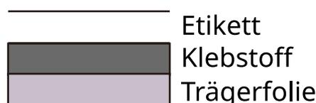
Etiketten bestehen aus drei Lagen, wie in der Abbildung gezeigt. Die Klebelage enthält Materialien, die leicht von den im Gerät angewandten Kraft beeinflusst werden. Die obere Lage haftet auf dem Trägerblatt, bis das Etikett verwendet wird. Diese Zusammensetzung von Etiketten kann zu weiteren Problemen führen.
