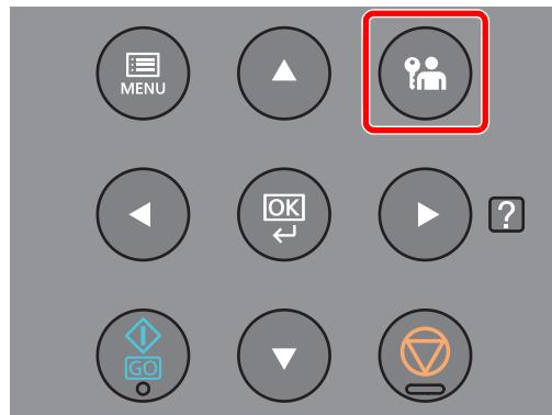
Pro odchod z nabídky nastavení zvolte tlačítko [**Logout**] a odhlásťte se. Tím se vrátíte zpět na normální obrazovku.
