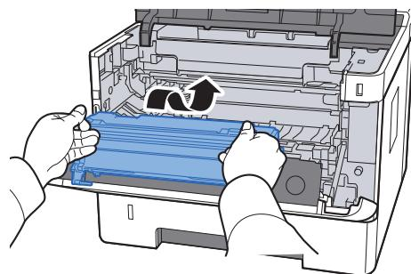
**13 Vrat'te jednotku vývojky se zásobníkem s tonerem zpět na místo a srovnejte vodítka na obou stranách s drážkami na zařízení.**
