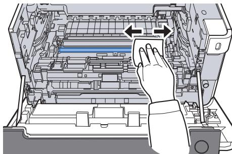
**7 Na jednotce válce přejed'te čističem hlavní nabíjecí jednotky 2krát až 3krát tam a zpět, a tím očistěte kabel nabíjecí jednotky.**
