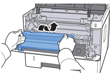
**9 Vrat'te jednotku vývojky se zásobníkem s tonerem zpět na místo a srovnejte vodítka na obou stranách s drážkami na zařízení.**
