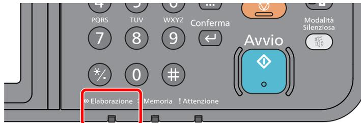
Quando è in arrivo un fax, l'indicatore **[Elaborazione]** lampeggia e la ricezione si avvia automaticamente.
