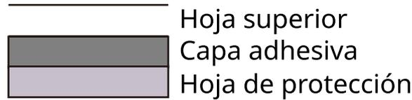
La etiqueta dispone de tres capas como se muestra en la ilustración. La capa adhesiva contiene sustancias que se pueden ver fácilmente afectadas por la fuerza aplicada en la máquina. La hoja de protección se mantiene con la hoja superior hasta que se utiliza la etiqueta. La composición de las etiquetas puede causar problemas.
