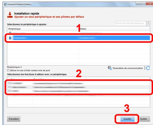
[Utiliser le nom d'hôte comme nom de port] peut aussi être sélectionné et configuré pour utiliser le nom d'hôte du port TCP/IP standard. (Une connexion USB ne peut pas être utilisée.)
