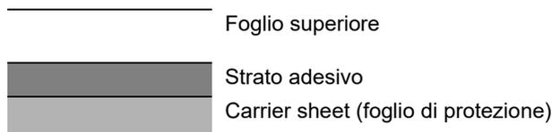
Come indicato in figura, le etichette sono composte da tre diversi strati. Lo strato adesivo contiene componenti molto sensibili alla forza applicata all'interno del sistema. Il carrier sheet supporta il foglio superiore fino a quando l'etichetta non viene utilizzata. Questa composizione di etichette potrebbe causare vari inconvenienti.
