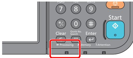
Quando chega um fax, o indicador **[Processing]** fica intermitente e a recepção inicia-se automaticamente.
