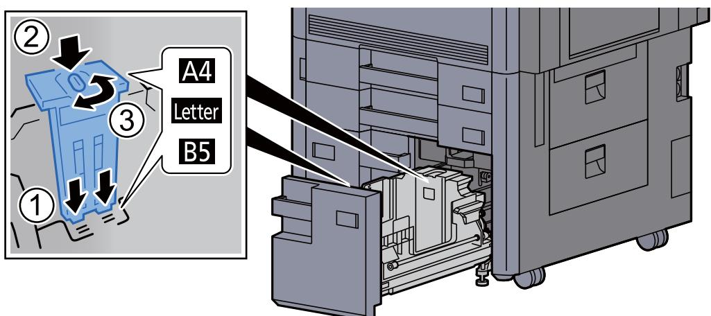
Kontrollér, at toppen af justeringsstyret for papirformatet (A) passer til det papirformat, der skal anvendes, fastgør klemmen, og drej klemmen for at låse.
