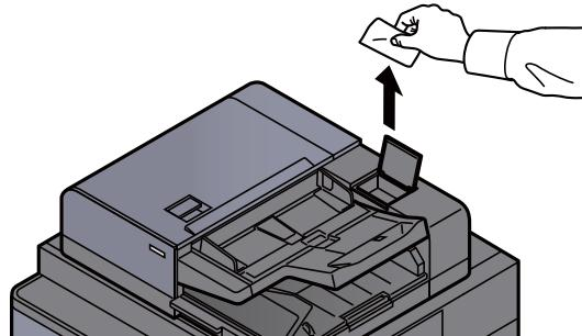
**2** Rengør glaspanelets overflade og læseguiden.
