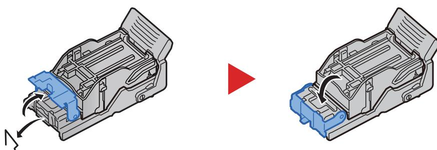
8 Montér holderen til hæfteklammebeholderen (A).
