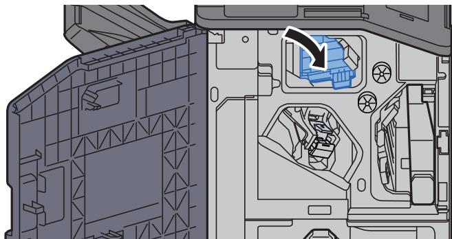
6 Fjern holderen til hæfteklammebeholderen (A).
