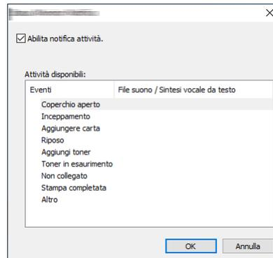
È possibile abilitare o escludere la notifica quando si verifica un errore inserito nell'elenco delle attività.
