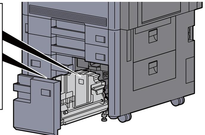
Asegúrese de que la parte superior de la guía de ajuste del tamaño del papel (A) coincide con el tamaño del papel que se va a utilizar, acople la abrazadera y gire la abrazadera para bloquearla.
