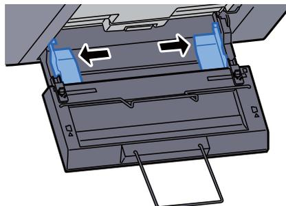
Asegúrese de que la bandeja de banner está instalada de manera que las guías de ajuste de la anchura del papel de la bandeja de banner están fuera de las guías de ajuste de la anchura del papel del bypass.
