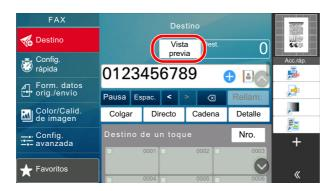
La máquina empieza a escanear el original. Una vez completado el escaneado, aparece la vista previa de la imagen en el panel.
