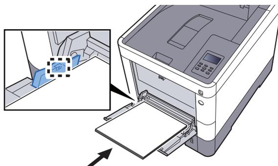
Insérer le papier dans le bac le long des guides jusqu'à ce qu'il se bloque.
