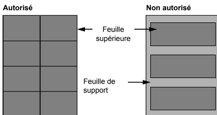
Utiliser du papier à étiquettes conforme aux spécifications suivantes.
