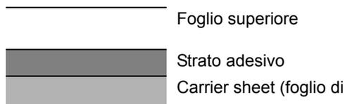
Come indicato in figura, le etichette sono composte da tre diversi strati. Lo strato adesivo contiene componenti molto sensibili alla forza applicata all'interno del sistema. Il carrier sheet supporta il foglio superiore fino a quando l'etichetta non viene utilizzata. Questa composizione di etichette potrebbe causare vari inconvenienti.
