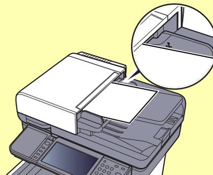
**Certifique-se de que os originais colocados não excedem o indicador de nível. Se exceder o nível máximo, os originais poderão encravar.**
