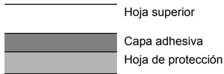
La etiqueta dispone de tres capas como se muestra en la ilustración. La capa adhesiva contiene sustancias que se pueden ver fácilmente afectadas por la fuerza aplicada en la máquina. La hoja de protección se mantiene con la hoja superior hasta que se utiliza la etiqueta. La composición de las etiquetas puede causar problemas.
