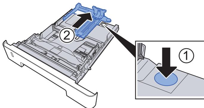
**3 Régler la position des guides de largeur de papier situés à gauche et à droite du magasin.**
