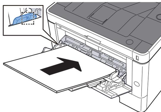
Insérer le papier dans le bac le long des guides jusqu'à ce qu'il se bloque.
