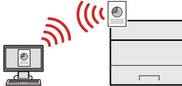
Si un environnement de réseau sans fil est disponible, il est possible d'installer l'unité sans se préoccuper du câblage réseau. En outre, Wi-Fi Direct, etc. sont également pris en charge.
