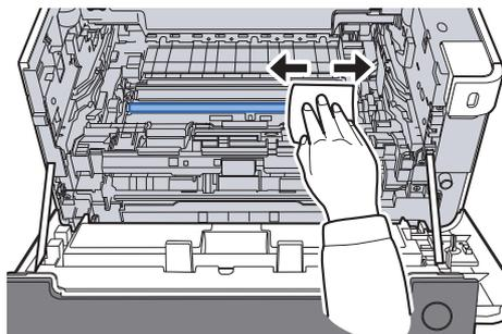
**7 Sur le tambour, faire coulisser le dispositif de nettoyage du chargeur principal d'avant en arrière 2 ou 3 fois pour nettoyer le fil du chargeur.**
