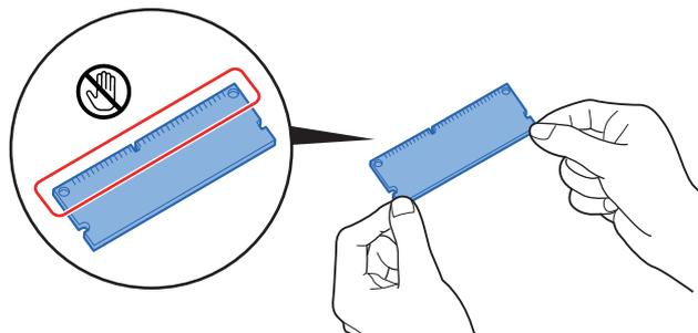
Um die elektronischen Bauteile zu schützen, muss die am Körper angesammelte statische Elektrizität abgeleitet werden, indem ein Wasserrohr oder ein anderes Metallobjekt berührt wird, bevor Sie die Speichermodule berühren. Während der Arbeit sollten Sie möglichst ein Antistatik-Armband tragen.
