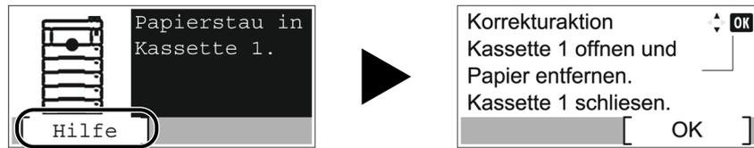
Mit der Taste **[▼]** gehen Sie zum nächsten Schritt und mit der Taste **[▲]** kehren Sie zum vorherigen Schritt zurück.
