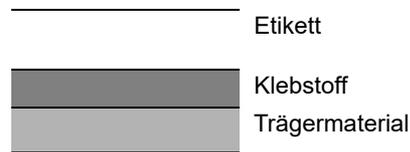
Etiketten bestehen, wie in der Abbildung zu sehen, aus drei verschiedenen Lagen. Der Klebstoff stellt für das Gerät das größte Risiko dar, denn er wird Druck und Wärme ausgesetzt. Die Trägerfolie trägt das Etikett beim Transport durch das Gerät. Die Kombination der verschiedenen Materialien kann Probleme verursachen.
