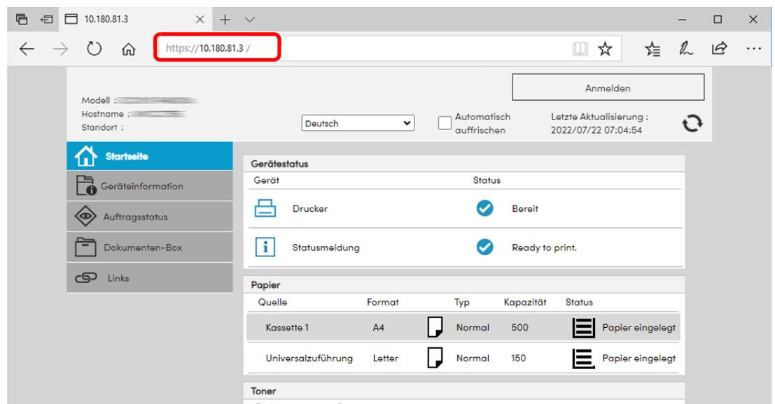
Die nun angezeigte Seite enthält Basisinformationen über das Gerät und den Embedded Web Server RX sowie die Angabe des aktuellen Status.
