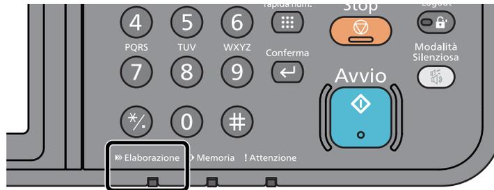
Quando viene ricevuto un fax, l'indicatore **[Elaborazione]** lampeggia e il sistema avvia automaticamente la ricezione.
