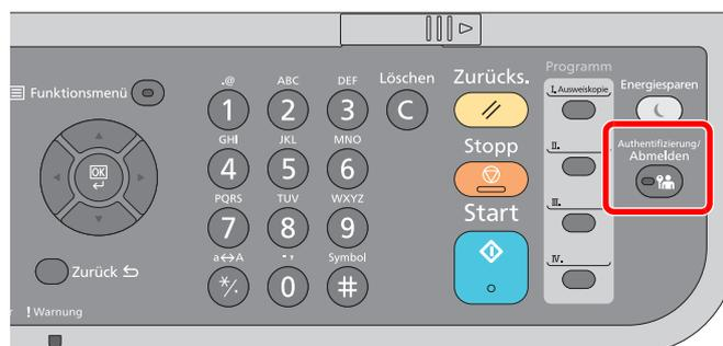
Wenn Sie sich am Gerät abmelden möchten, wählen Sie die Taste **[Authentifizierung/Abmelden]**. Die Anzeige zur Eingabe des Login-Namens und des Login-Passworts wird wieder eingeblendet.
