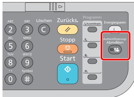
Wenn Sie sich am Gerät abmelden möchten, wählen Sie die Taste **[Authentifizierung/Abmelden]**. Die Anzeige zur Eingabe des Login-Namens und des Login-Passworts wird wieder eingeblendet.
