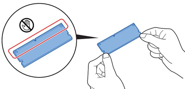
Per proteggere i componenti elettronici, scaricare l'elettricità statica dal proprio corpo toccando un condotto dell'acqua (rubinetto) o altro oggetto metallico grande prima di manipolare i moduli memoria. Oppure, indossare un bracciale antistatico, se possibile, quando si installano i moduli memoria.
