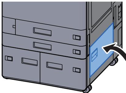
**5 Se o alimentador lateral opcional estiver instalado, volte a tampa na posição original.**
