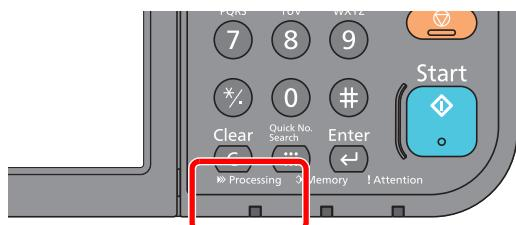
Quando chega um fax, o indicador [Processing] fica intermitente e a recepção inicia-se automaticamente.
