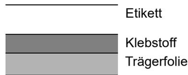
Etiketten bestehen, wie in der Abbildung zu sehen, aus drei Lagen. Der Klebstoff stellt für das Gerät das größte Risiko dar, denn er wird Druck und Wärme ausgesetzt. Die Trägerfolie trägt das Etikett beim Transport durch das Gerät. Die Kombination der verschiedenen Materialien kann Probleme verursachen.
