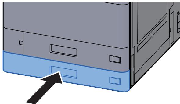
**9 Falls die optionale seitliche Papierzufuhr installiert ist, müssen Sie diese wieder an die ursprüngliche Position schieben.**
