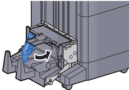
**8 Obere Abdeckung der Falteinheit öffnen.**
