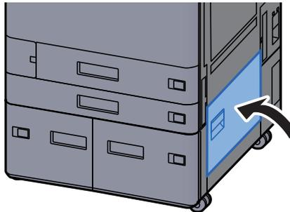
**5 Falls die optionale seitliche Papierzufuhr installiert ist, müssen Sie diese wieder an die ursprüngliche Position schieben.**
