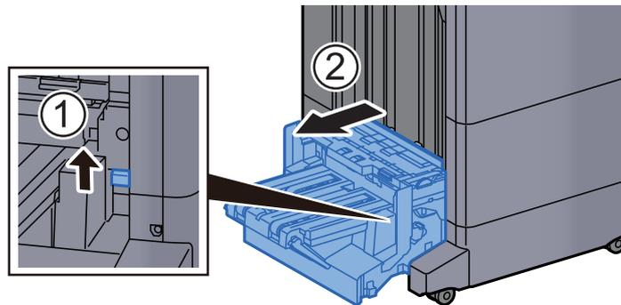
**8 Obere Abdeckung der Falteinheit öffnen.**
