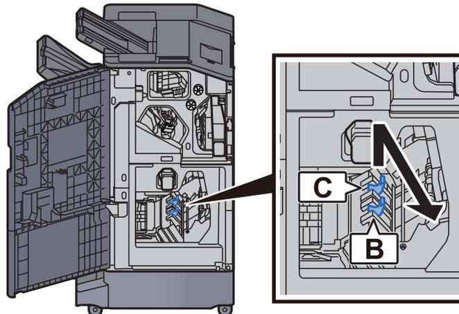
**4 Die eingeklemmte Heftklammer entfernen.**
