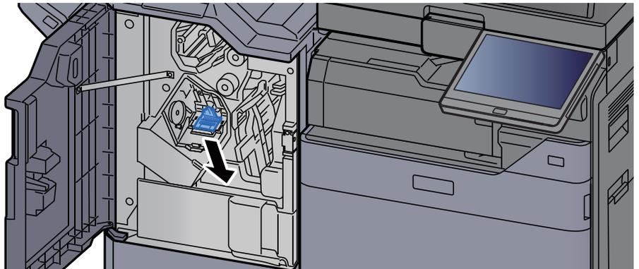
**7 Die eingeklemmte Heftklammer entfernen.**
