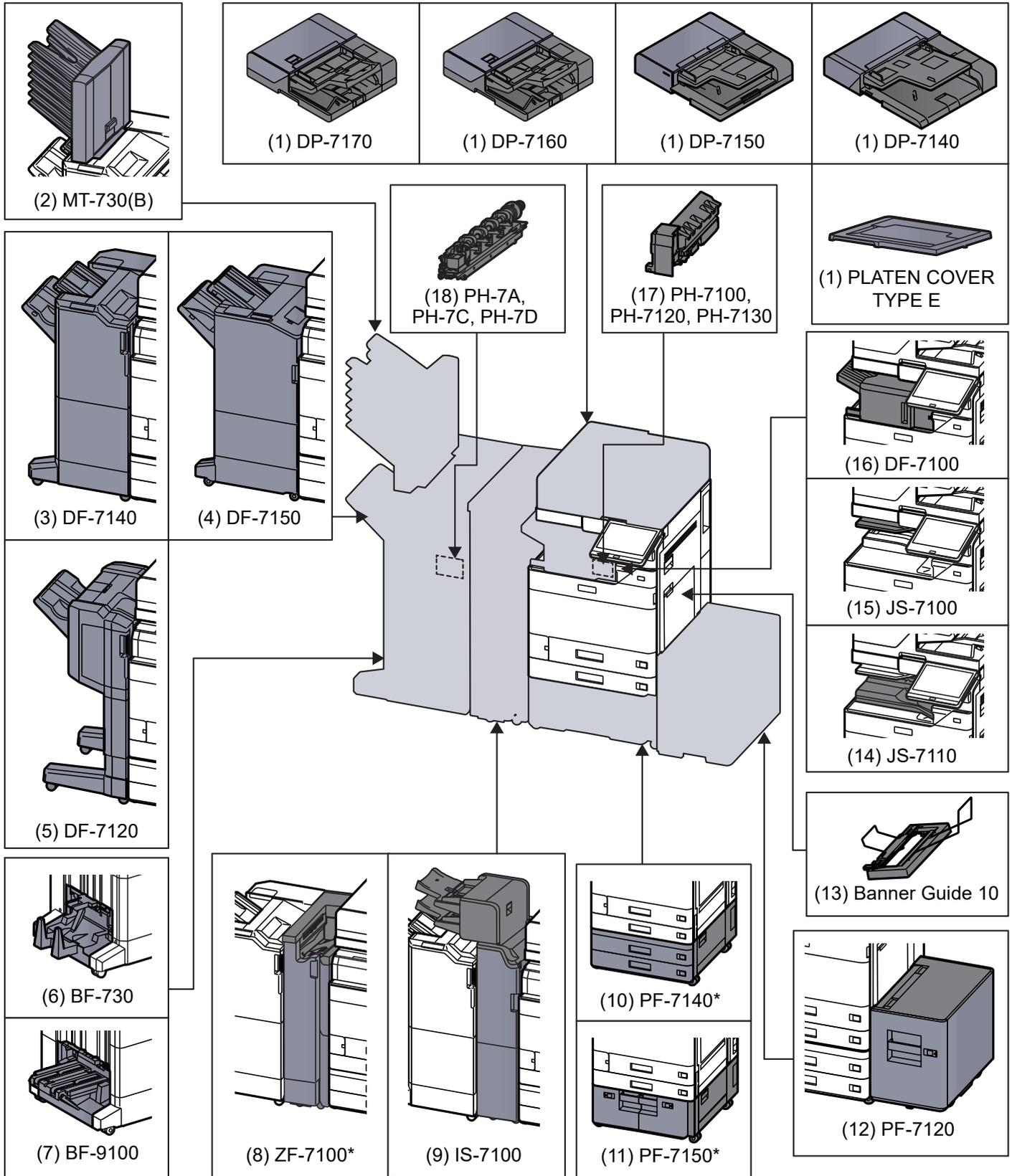
\* Wenn eine der folgenden Optionen verwendet wird, muss der Druckersockel installiert werden: PF-7140, PF-7150, PF-7120
