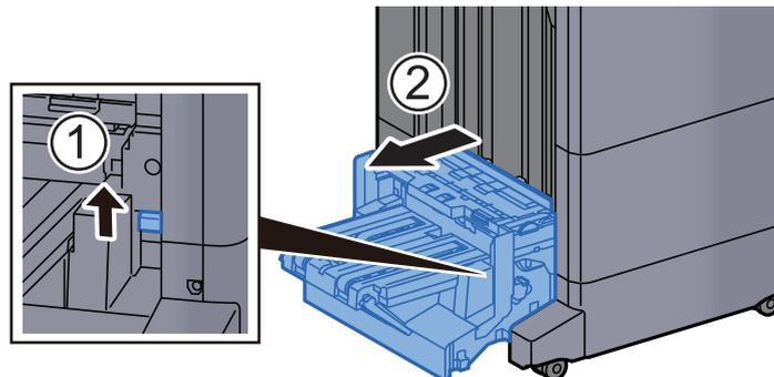
**11 Obere Abdeckung der Falteinheit öffnen.**
