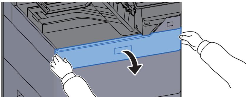
Die Abdeckung des leeren Tonerbehälters ist geöffnet.
