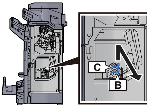
**4 Die eingeklemmte Heftklammer entfernen.**
