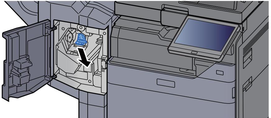
**10 Die eingeklemmte Heftklammer entfernen.**
