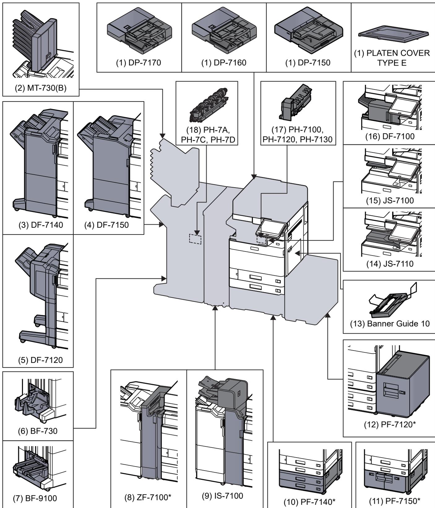
\* Se è installata una delle seguenti opzioni, occorre installare il kit anti-ribaltamento: PF-7140, PF-7150, PF-7120
