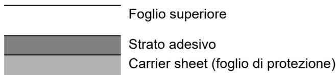
Come indicato in figura, le etichette sono composte da tre diversi strati. Lo strato adesivo contiene componenti molto sensibili alla forza applicata all'interno del sistema. Il carrier sheet supporta il foglio superiore fino a quando l'etichetta non viene utilizzata. Questa composizione di etichette potrebbe causare vari inconvenienti.
