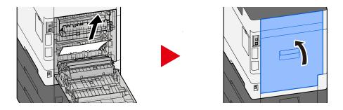
3 Die hintere Abdeckung 2 öffnen und das gestaute Papier entfernen.
