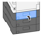
3 Die hintere Abdeckung 3 öffnen und das gestaute Papier entfernen.
