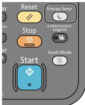
Sollten während des Ruhemodus Druckdaten empfangen werden, wird das Gerät automatisch aktiviert und druckt.
