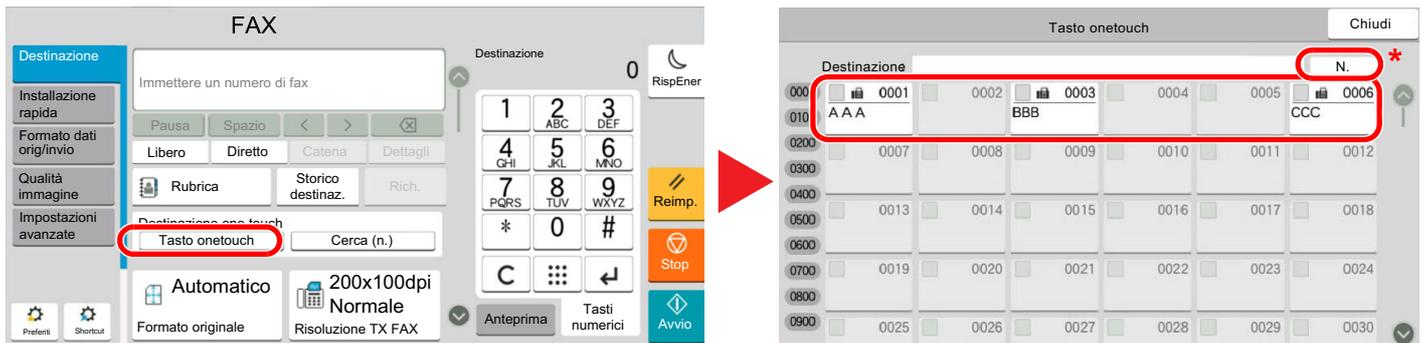
\* Il tasto [N.] svolge la stessa funzione del pulsante [Cerca (n.)] visualizzato sul pannello a sfioramento. Utilizzare questo tasto per immettere direttamente un numero con il tastierino numerico. Ad esempio per specificare un indirizzo di trasmissione con un numero di un tasto one touch o per richiamare un programma registrato utilizzando il numero programma. Per informazioni sui numeri dei tasti one touch, vedere:
