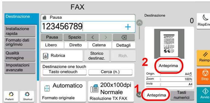
Il sistema avvia la scansione dell'originale. Una volta completata la scansione, sul pannello viene visualizzata l'immagine di anteprima.
