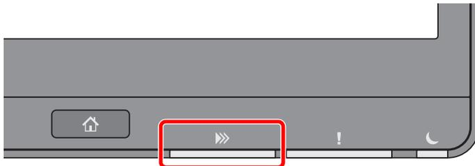
Quando è in arrivo un fax, l'indicatore **[Dati]** lampeggia e la ricezione si avvia automaticamente.
