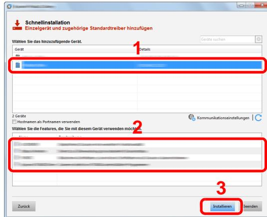
Sie können auch die Einstellung **[Hostnamen als Portnamen verwenden]** auswählen, um den Hostnamen für die Bezeichnung des Standard TCP/IP-Anschlusses zu verwenden. (Eine USB-Verbindung kann nicht verwendet werden.)
