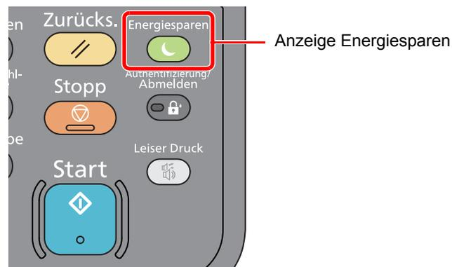
Sollten während des Ruhemodus Druckdaten empfangen werden, startet das Gerät automatisch und druckt.
