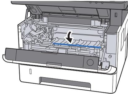
12 Trommeleinheit in die ursprüngliche Position einsetzen.
