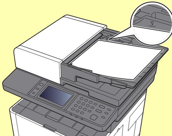
**Die eingelegten Originale dürfen die angegebene Grenze nicht überschreiten. Wenn die maximale Stapelhöhe überschritten wird, kann ein Stau bei den Originalen auftreten.**
