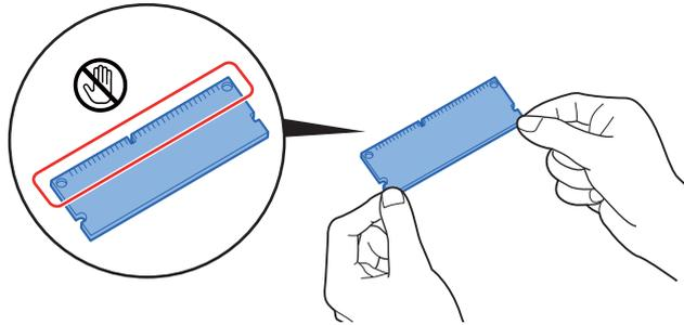
Um die elektronischen Bauteile zu schützen, muss die am Körper angesammelte statische Elektrizität abgeleitet werden. Verwenden Sie dazu bitte eine antistatische Armband. Falls Sie kein antistatisches Armband haben, berühren Sie ein metallenes Objekt, um die statische Elektrizität abzuleiten.
