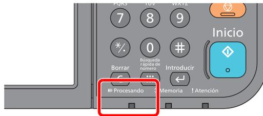
Cuando entra un fax, el indicador **[Procesando]** parpadea y se inicia automáticamente la recepción.
