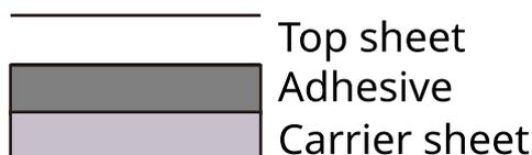
Come indicato in figura, le etichette sono composte da tre diversi strati. Lo strato adesivo contiene componenti molto sensibili alla forza applicata all'interno del sistema. Il carrier sheet supporta il foglio superiore fino a quando l'etichetta non viene utilizzata. Questa composizione di etichette potrebbe causare vari inconvenienti.
