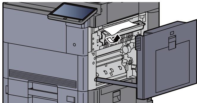
**5 Vrat'te kryt fixační jednotky do původní polohy.**
