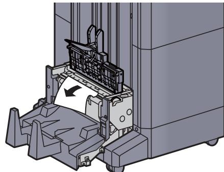
**20 Vrat'te horní kryt skládací jednotky do původní polohy.**
