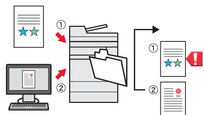
Pokud se při určování zvláštních formátů nebo typů papíru vyskytne chyba, že v zásobníku není papír, zařízení tuto chybovou úlohu přeskočí a provede další úlohu.
