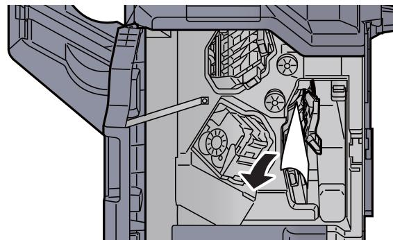
**5 Vrat'te vodítko dopravníku (D6) do původní polohy.**
