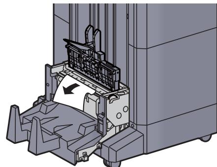
**11 Vrat'te horní kryt skládací jednotky do původní polohy.**
