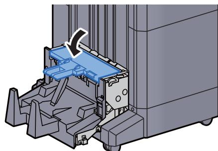
**21 Vrat'te skládací jednotku do původní polohy.**
