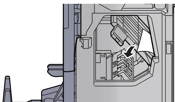
**7 Vrat'te vodítko dopravníku (D8) do původní polohy.**
