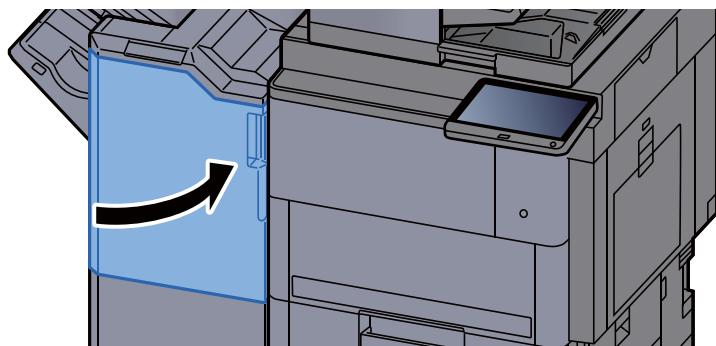
**Odstranění vzpříčeného papíru z dokončovací jednotky na 4000 listů/z dokončovací jednotky sešívání na 100 listů (Příhrádka B)**
