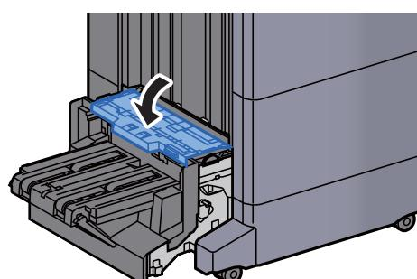
**20 Vrat'te skládací jednotku do původní polohy.**
