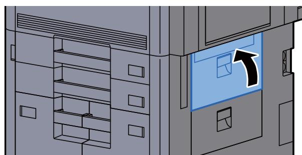
**5 Je-li nainstalován volitelný boční podavač, vrat'te jej do původní polohy.**
