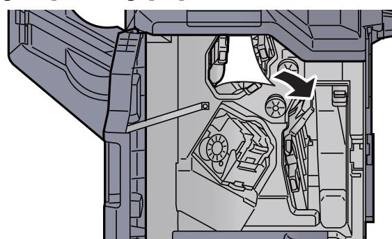
**5 Vrat'te vodítko dopravníku (D4) do původní polohy.**
