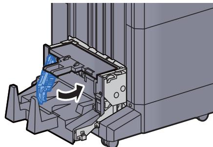
**14 Otevřete horní kryt skládací jednotky.**
