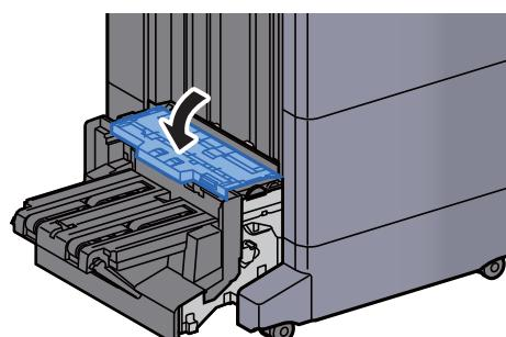
**11 Vrat'te skládací jednotku do původní polohy.**
