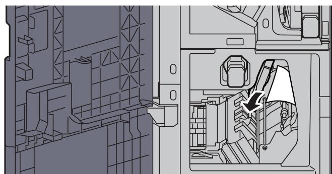
**7 Vrat'te vodítko dopravníku (D8) do původní polohy.**
