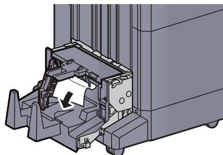
**7 Vrat'te levý kryt skládací jednotky do původní polohy.**
