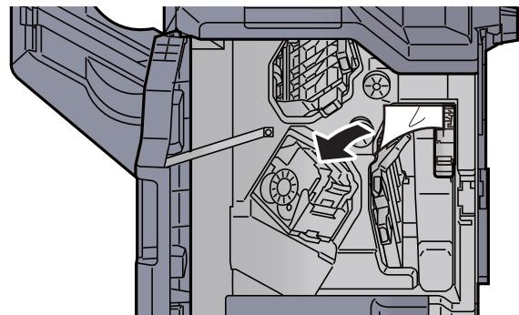
**4 Vrat'te vodítko dopravníku (D1) do původní polohy.**
