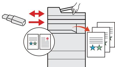
Je užitečná, pokud chcete své dokumenty tisknout mimo kancelář nebo nemůžete dokumenty vytisknout z vašeho počítače. Můžete vytisknout dokumenty uložené na jednotce USB přímo jejím zapojením do zařízení. Na jednotku USB lze také uložit originály, které jste právě naskenovali do zařízení.
