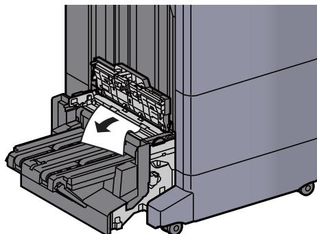
**14 Otevřete vodítko dopravníku skládací jednotky.**
