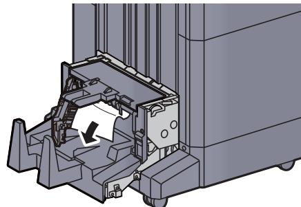
**13 Vrat'te levý kryt skládací jednotky do původní polohy.**
