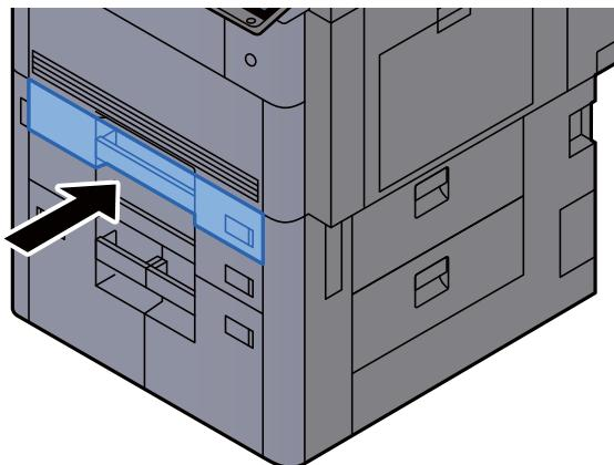
**9 U zásobníku 1 a 2 vložte list požadovaného formátu a typu papíru tak, jak je znázorněno na obrázku.**
