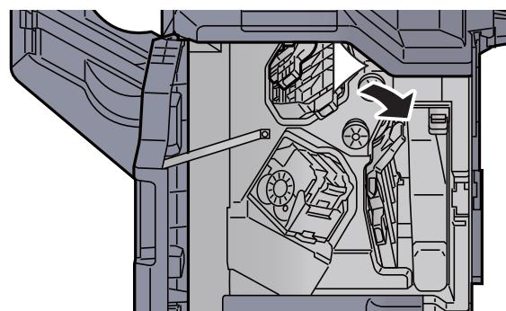
**6 Vrat'te vodítko dopravníku (D2) do původní polohy.**
