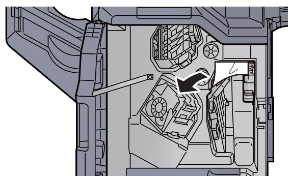
**9 Vrat'te vodítko dopravníku (D1) do původní polohy.**
