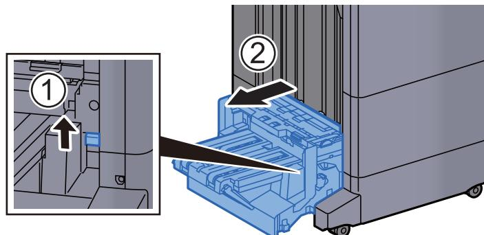
**8 Otevřete horní kryt skládací jednotky.**
