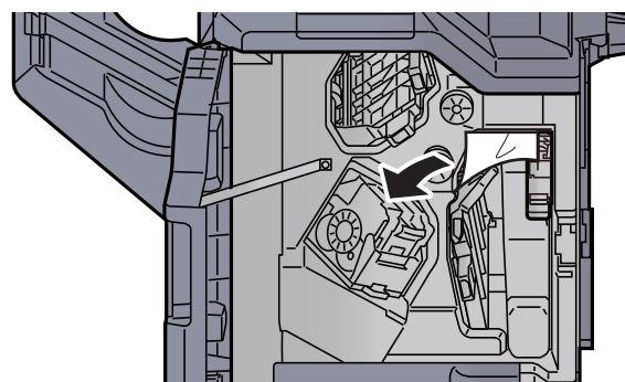
**12 Vrat'te vodítko dopravníku (D1) do původní polohy.**
