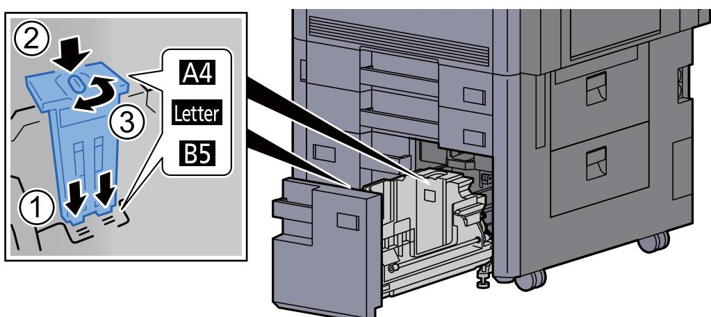
Zkontrolujte, zda vršek vodítka formátu papíru (A) odpovídá formátu papíru, který se bude používat, zasuňte úchytku a otočením ji zajistěte.
