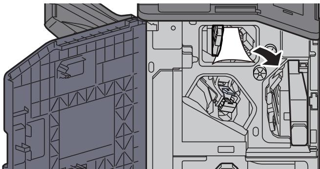
**5 Vrat'te vodítko dopravníku (D4) do původní polohy.**
