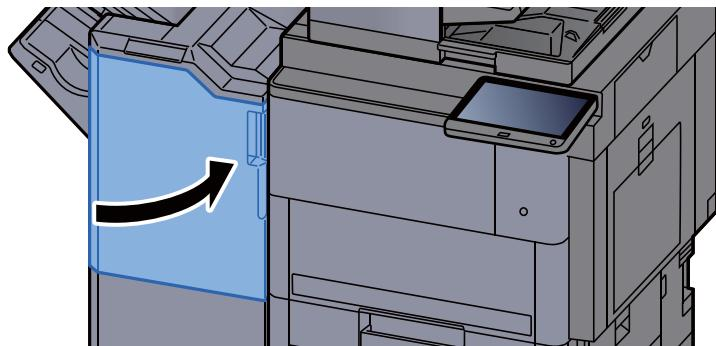
**Odstranění vzpříčeného papíru ze skládací jednotky
