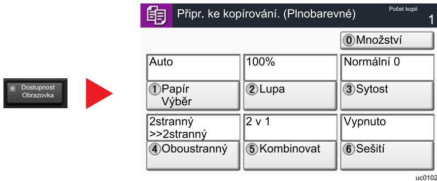
Obrazovku můžete ovládat také pomocí číselné klávesy, která odpovídá číslu v kroužku. (Příklad: Pro přiblížení stiskněte klávesu [2] na číselné klávesnici.)
