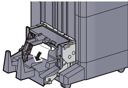
**16 Vrat'te levý kryt skládací jednotky do původní polohy.**
