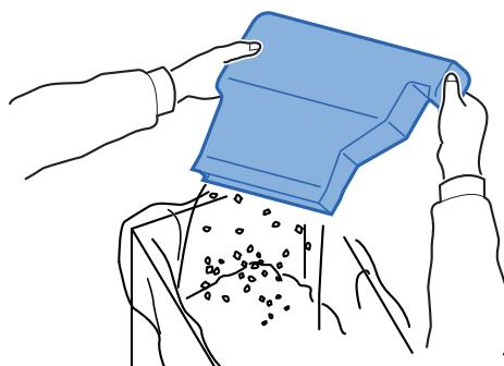
**4 Vrat'te odpadní nádobku na děrování do zařízení.**
