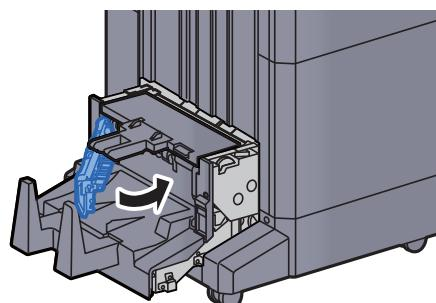
**8 Otevřete horní kryt skládací jednotky.**
