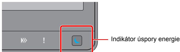
Jsou-li v režimu spánku přijata tisková data, zařízení se automaticky probudí a začne tisknout.
