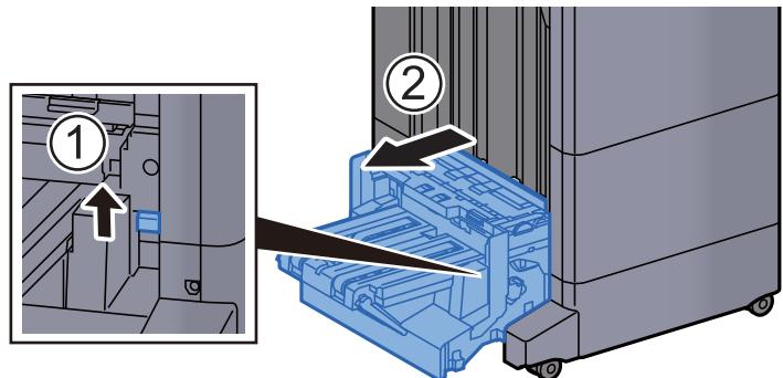
**11 Otevřete horní kryt skládací jednotky.**
