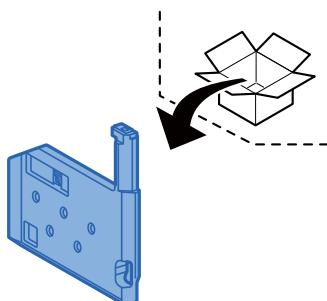
**5 Vložte odpadní nádobku na toner dovnitř zařízení.**
