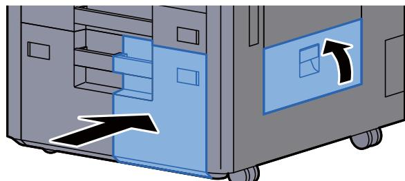
**7 Je-li nainstalován volitelný boční podavač, vrat'te jej do původní polohy.**
