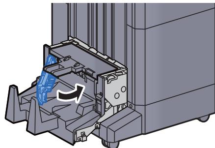
**17 Otevřete horní kryt skládací jednotky.**
