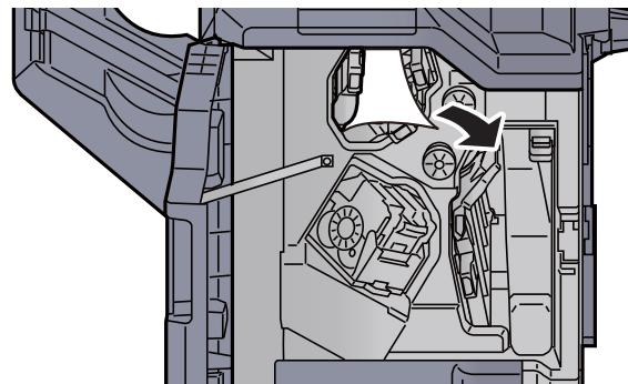
**9 Vrat'te vodítko dopravníku (D4) do původní polohy.**
