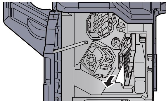
**4 Vrat'te vodítko dopravníku (D7) do původní polohy.**
