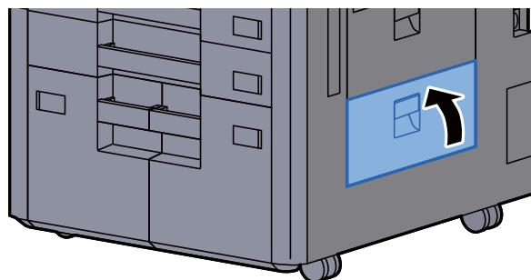
**11 Je-li nainstalován volitelný boční podavač, vrat'te jej do původní polohy.**
