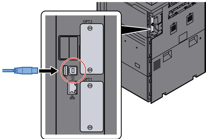
**3** Vložte kabel do drážky.
