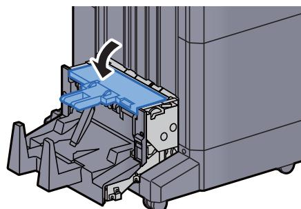
**18 Vrat'te skládací jednotku do původní polohy.**
