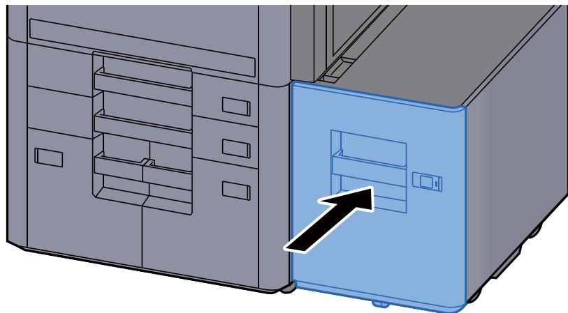
**4 Vložte cedulku tak, aby odpovídala formátu a typu papíru, který se má do zařízení vkládat.**
