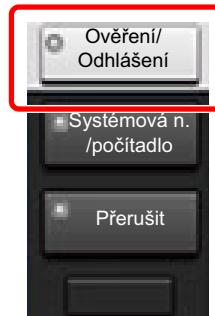
Chcete-li se ze zařízení odhlásit, stiskněte tlačítko [**Ověření/Odhlášení**] a vratěte se na úvodní obrazovku pro zadání přihlašovacího uživatelského jména a hesla.
