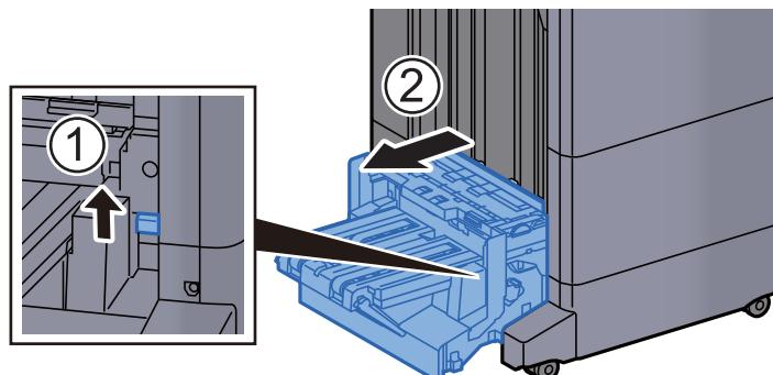
**2 Otevřete horní kryt skládací jednotky.**
