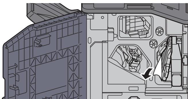
**4 Vrat'te vodítko dopravníku (D7) do původní polohy.**
