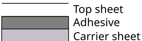
Etiketten bestehen aus drei Lagen, wie in der Abbildung gezeigt. Die Klebelage enthält Materialien, die leicht von den im Gerät angewandten Kraft beeinflusst werden. Die obere Lage haftet auf dem Trägerblatt, bis das Etikett verwendet wird. Diese Zusammensetzung von Etiketten kann zu weiteren Problemen führen.
