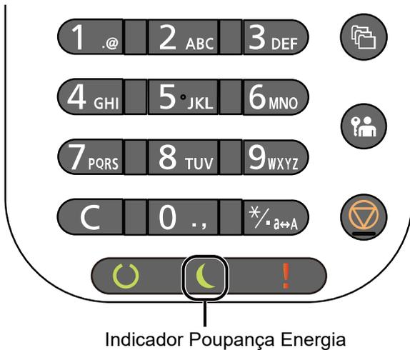
Se os dados de impressão forem recebidos durante o modo de espera, a máquina recupera do modo de espera automaticamente e a impressão é iniciada.
