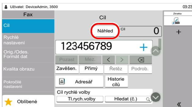
Zařízení začne skenovat originál. Po dokončení skenování se na panelu zobrazí náhled.
