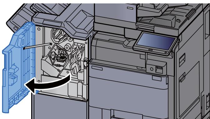
2 Fjern holderen til hæfteklammebeholderen (A).
