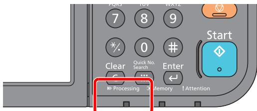
Når en faks kommer inn, blinker indikatoren [**Processing**] og mottak starter automatisk.
